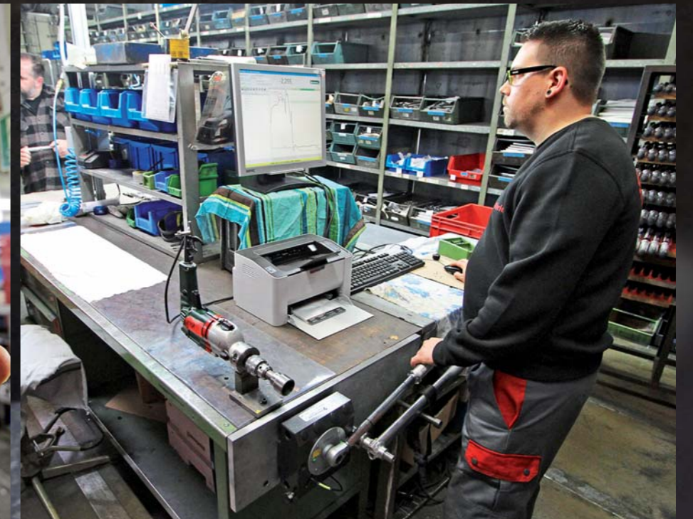
Sascha Werle kalibriert alle Drehmomentschlüssel in mehreren Schritten elektronisch überwacht. Bei Werten im Toleranzbereich gibt es ein Prüzfertifikat
